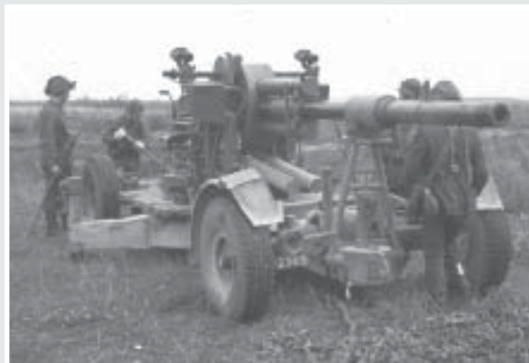
7,5 cm kustartilleripjäs m/65 under gruppering. Eldrörets mynning var perforerad. Detta var en mynningsbroms vars uppgift var att begränsa rekylan. Eftersom fasta pjäser var försedda med ett tungt rekylreducerande system, vilket gav ett stort motstånd, erfordrades mynningsbroms endast för rörliga pjäser. Utbuktningen på eldrörets halva längd är en krutgasejektor, vars uppgift var att ventilera krutgaserna
