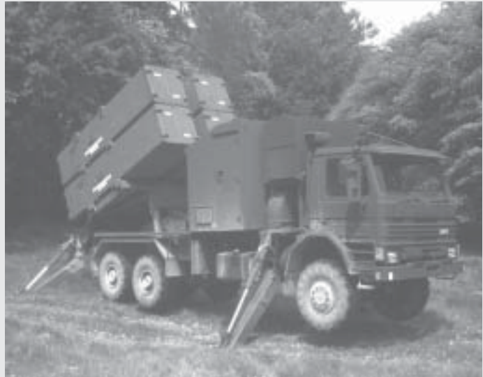
Fordon med eleverat robotställ för fyra stycken kustrobot 15. Efter start med hjälp av två krutrakettmotorer drivs Rb 15 av en turbojetmotor, vars fart var cirka mach 1. Roboten kan anflyga mycket lågt och har radar-målsökare.
