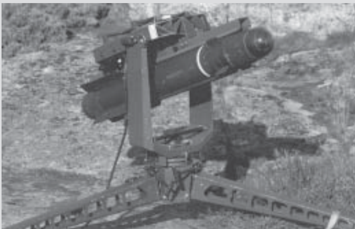
Kustrobot 17, Hellfire, utvecklades ursprungligen i USA som en helikopterburna pansarvärnsrobot. Den amerikanska stridsdelen har bytts ut mot en av Bofors utvecklad sjömålsstridsdel. Robotens målsökare leder roboten mot den från målet reflekterade strålningens energi från laserbelysaren. Prestanda och träffresultat är mycket goda.
