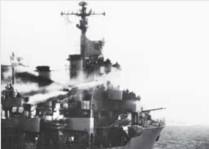
Rb 315 (försöksrobot till Rb 08) avfyras från Halland. Jagarna Halland och Småland var de första sjömålsrobotbestyckade jagarna i västvärlden.
