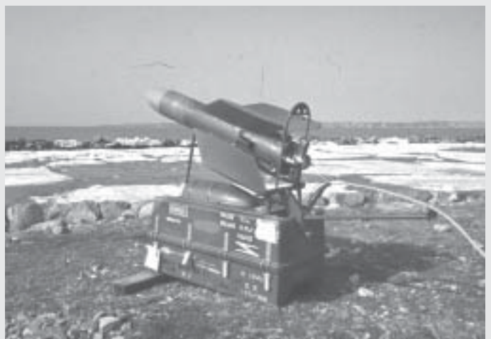
Rb 52 övning klar för avfyring. Denna robot var ursprungligen en fransk pansarvärnsrobot. Den var trådstyrd och styrdes manuellt av en skytt med joystick. Det fanns många tekniska svagheter i systemet, vilket medförde att många robotar gick i havet utan att nå sitt mål.
